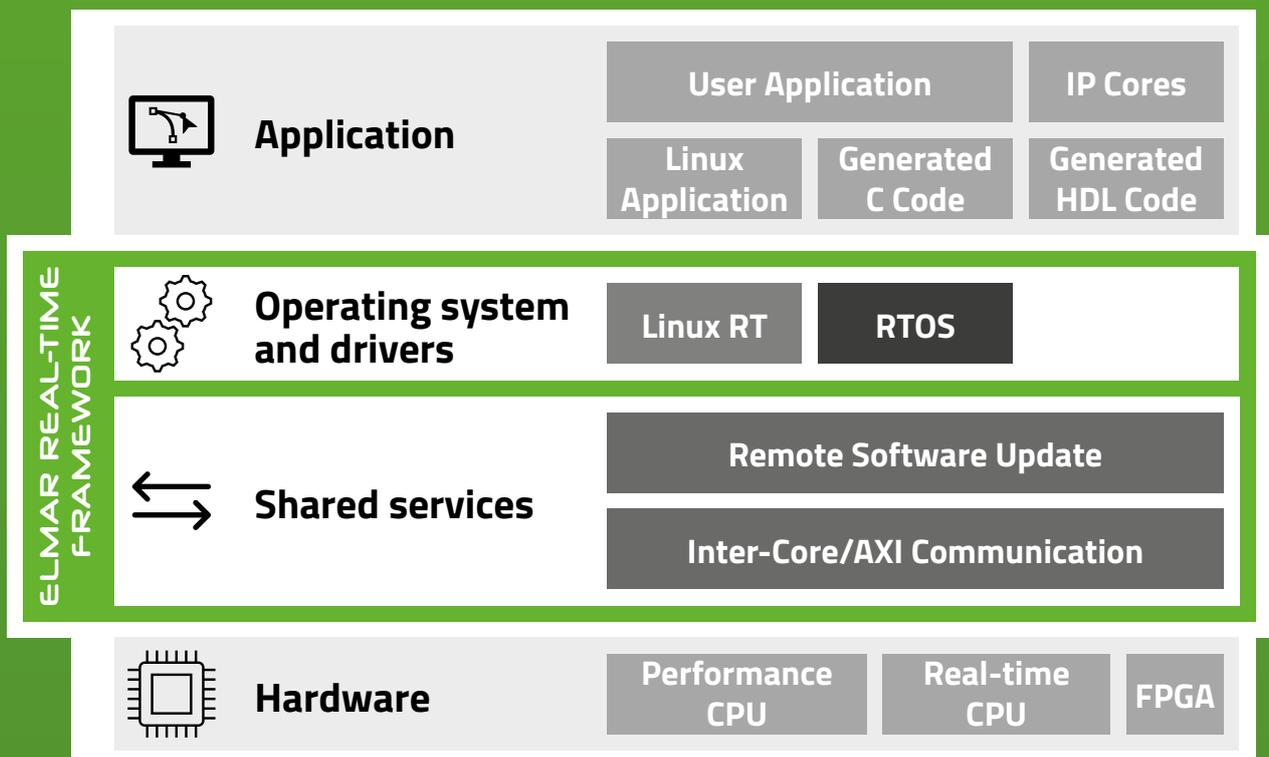
Durch den Einsatz unseres Kernel-Patches, welcher speziell für diese Plattform entwickelt wurde, können wir einen stabilen 10kHz Takt auf den Echtzeitkernen sicherstellen. Gemessen wurde dieser mit einem komplexen industriellen Simulink®-Regelalgorithmus.
